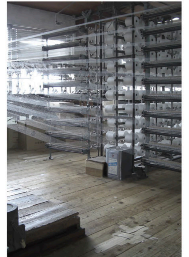
織機にセットされた数百本にもおよぶ紙摺糸は、整経台へと巻かれてゆく。
